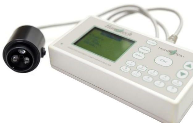
Εικόνα 11: Handy Plant Efficiency Analyzer για τις μετρήσεις επαγωγικού φθορισμού. Η εικόνα λήφθηκε από την παραπομπή IV .
