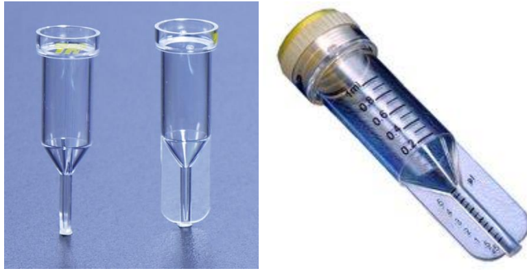
Εικόνα 8: Βαθμονομημένοι τριχοειδείς σωλήνες PCV. Η εικόνα λήφθηκε από την παραπομπή 1,11 .
