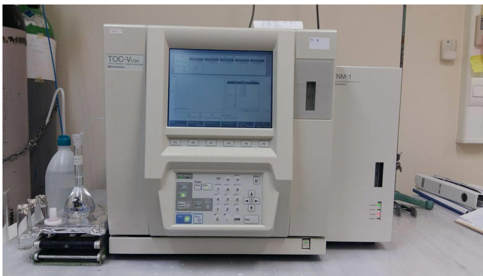
Εικόνα 16: Ο αναλυτής ολικού οργανικού άνθρακα (TOC-V CSH /CSN Analyzer Shimadzu)-ολικού υδατοδιαλυτού αζώτου (TNM-1 Analyzer, Shimadzu).
