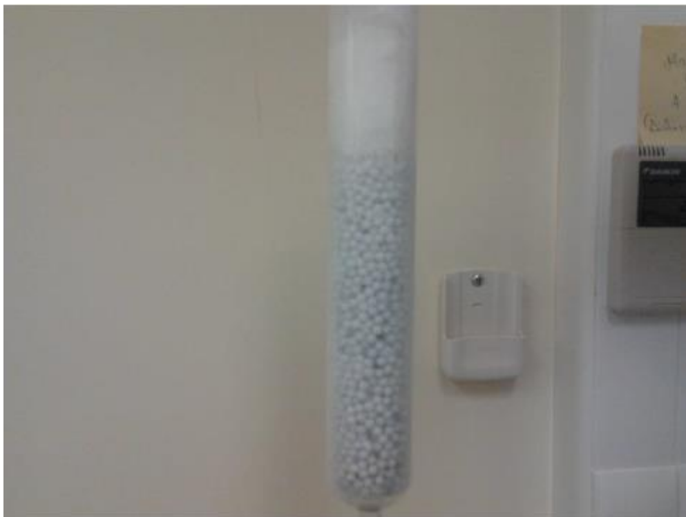
Εικόνα 18: Καταλύτης οξείδωσης (Pt) του αναλυτή ολικού οργανικού άνθρακα (TOC-V CSH/CSN Analyzer Shimadzu)-ολικού υδατοδιαλυτού αζώτου (TNM-1 Analyzer, Shimadzu).
