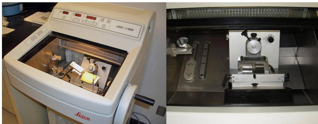
Εικόνα: Η κρυοτόμος της Leica που χρησιμοποιήθηκε για το sectioning των ιστών
