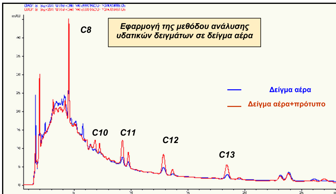
Σχήμα 3.2 Δείγμα αέρα και δείγμα αέρα με πρότυπο μίγμα ομόλογων LAS σαν “additional standard” με την μέθοδο εκχύλισης των υδατικών δειγμάτων.
