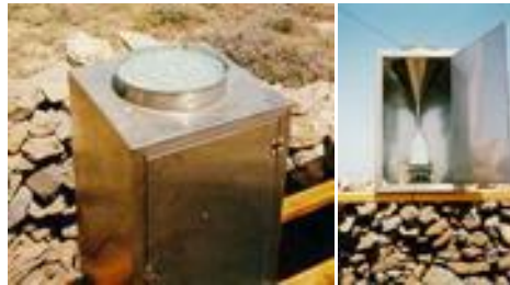
Εικόνα 3.3: Συλλέκτης ξηρής εναπόθεσης, Σταθμός Συλλογής Ατμοσφαιρικών Δεδομένων - Φινοκαλιάς.
