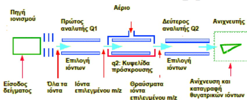
Εικόνα 7: Σχηματική αναπαράσταση του αναλυτή μαζών με σύστημα τριών τετραπόλων. Να σημειωθεί ότι στην παρούσα εργασία, ο φασματογράφος μάζας που χρησιμοποιείται (TSQ Quantum, Thermo Finnigan) είναι εφοδιασμένος με γωνιακό δεύτερο τετράπολο (κυψελίδα πρόσκρουσης) και όχι ευθύγραμμο όπως στην εικόνα.
