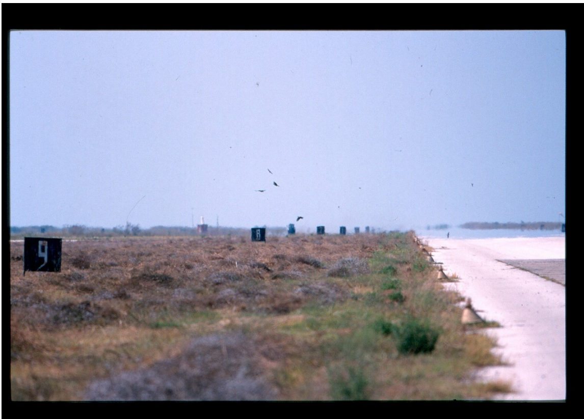
Εικόνα 7-9: Ενδείκνυται η εφαρμογή "hot foot" στην επάνω επιφάνεια των πινακίδων σήμανσης του αεροδρομίου
