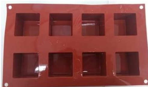
Εικόνα 13. Καλούπι σιλικόνης για την κατασκευή των δοκιμίων διαστάσεων 5×5 cm 3
