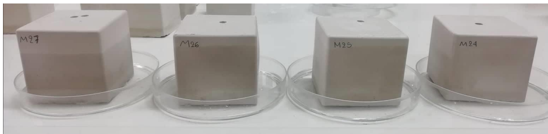
Εικόνα 14. Παραδείγματα εμβάπτισης δοκιμίου στα διαλύματα του Φωσφονικού υποκαταστάτη και Μεταλλοφωσφονικών ενώσεων με αλκαλικές γαίες (Ca 2+ , Ba 2+ , Mg 2+ , Sr 2+ )
