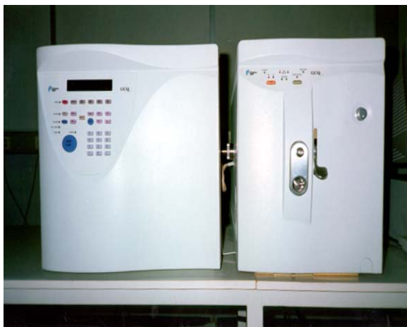
Σχήμα 7.5 Αέριος χρωματογράφος συνδυασμένος με διπλό φασματογράφο μάζας παγίδας ιόντων (GC-ITMS/MS)
