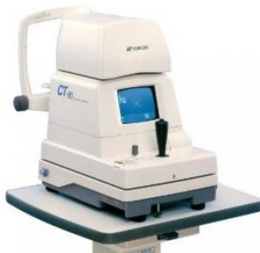
Εικόνα 5.5.2: Το τονόμετρο αέρος (Air puff)
