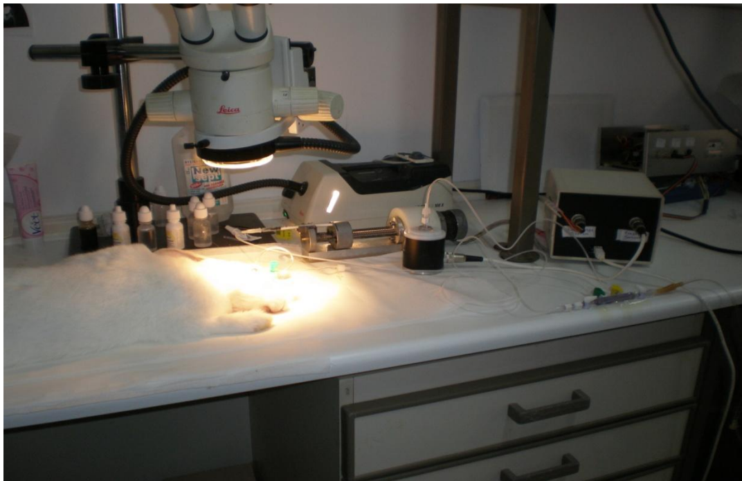
Εικόνα 7.2.1: Η επεμβατική μανομετρική συσκευή μέτρησης. Κεντρικά ο αισθητήρας πίεσης, πίσω αριστερά ο μηχανισμός δοσολογίας του ισότονου διαλύματος, μπροστά δεξιά τα ανελαστικά σωληνάρια και οι στρόφιγγες και πίσω δεξιά ο μετατροπέας (γκρι κουτί).
