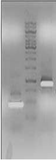
Εικόνα 16: Αναπαράσταση του πηκτώματος αγαρόζης μετά την απομόνωση των δύο τμημάτων που περιείχαν τις PCR1a,b.
