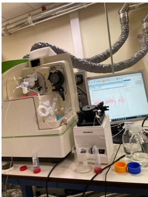
Εικόνα 2.18: Η πειραματική διάταξη που στήθηκε στο εργαστήριο για τα πτητικά υδρίδια As.
