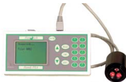
Εικόνα 16. Handy PEA για τις μετρήσεις του επαγωγικού φθορισμού
