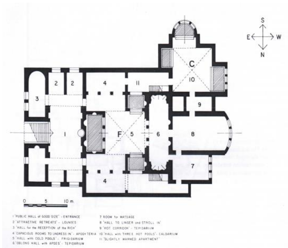
Εικ. 20: Κάτοψη του ιδανικού λουτρού από το έργο, Ιππία ή Βαλανείον , του Λουκιανού. Σχέδιο του F. Yegül. (Yegül 1992, σελ. 84).
