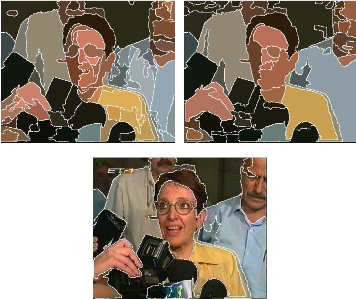
Σχήμα 7.13: Τμηματοποίηση στους χώρους GLHS (πάνω αριστερά) και Lab (πάνω δεξιά) και συγχώνευση (κάτω εικόνα) στο χώρο Lab για την ΕΙΚΟΝΑ1
