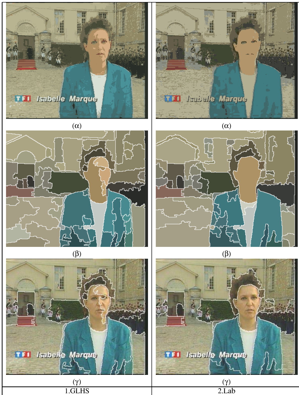
Σχήμα 7.18: Κυρίαρχα χρώματα (α), τμηματοποίηση (β) και συγχώνευση περιοχών (γ) για το GLHS (1) και για το Lab (2) για την EIKONA5
