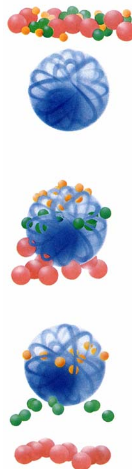
Εικόνα 3.2 Καθώς το μοριακό μίγμα περνά μέσα από τη στήλη τα μικρότερα μόρια συγκρατούνται για μεγαλύτερο χρόνο στους πόρους του προσροφητή και εκλύονται αργότερα από τα μεγαλύτερα μόρια (η εικόνα αναπαράχθηκε από τον οδηγό χρωματογραφικών υλικών “Standard Chromatography media guide” της Pharmacia).
