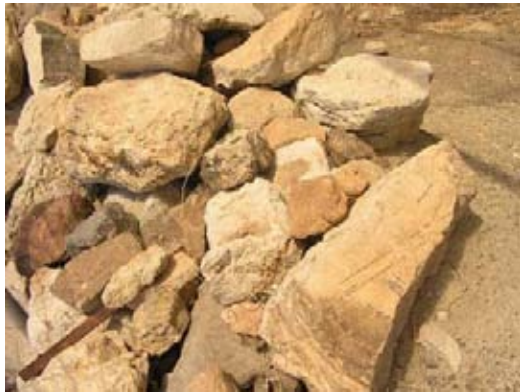
Εικ. Ρ303 α-β: Αποδούλου, ως δομικό υλικό έχει χρησιμοποιηθεί ανοιχτός τεφρός ασβεστόλιθος με χαλαζιακές φλέβες.
