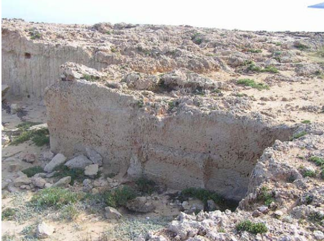
Εικ. X74. Σταυρός Ακρωτηρίου. Δυτικό λατομείο. Προετοιμασία μετώπου με λοξές κρούσεις.
