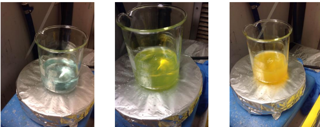
Εικόνα 3.1. Σταδιακή αλλαγή του χρώματος του διαλύματος από μπλε σε πορτοκαλί κατά την πρόοδο της αντίδρασης σχηματισμού \text{Cu}_2\text{O}
