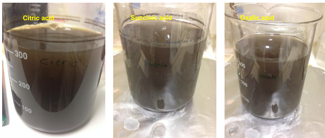
Εικόνα 3.5. Φωτογραφίες των διαλυμάτων με τους τρεις διαφορετικούς αναγωγικούς παράγοντες λίγο πριν μπουν στην φυγόκεντρο
