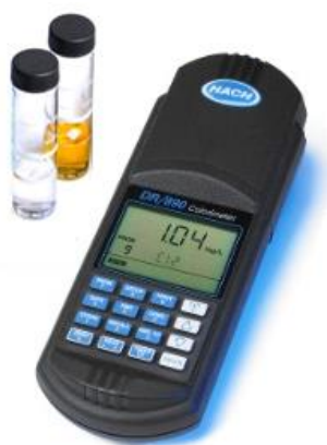
Εικόνα Β.1: Φασματοφωτόμετρο DR/890.
