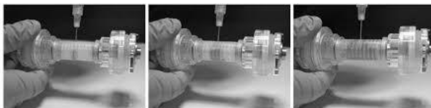
Εικόνα 2.4: Το δείγμα εισάγεται στον θάλαμο εστίασης με τη βοήθεια σύριγγας.
