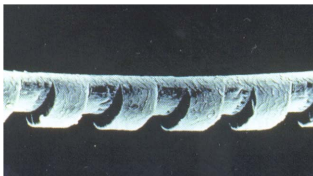
Εικόνα 18. Εικόνα από ηλεκτρονικό μικροσκόπιο σάρωσης, χάραξης μέσω φωτοεκτομής με Excimer laser σε ανθρώπινη τρίχα
