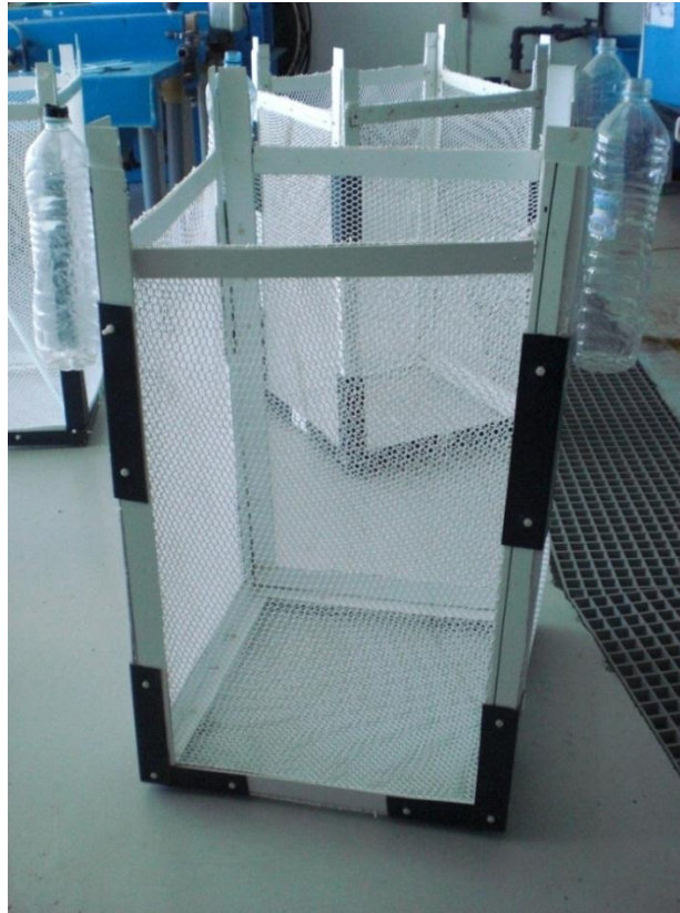
Εικόνα 5. Χειροποίητος κλωβός (x6) για τη διεξαγωγή πειραμάτων συμπεριφοράς.
