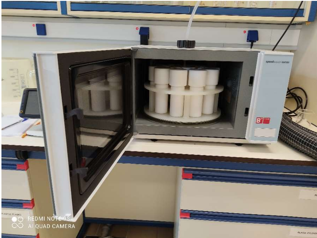
Εικόνα 23 Ο φούρνος μικροκυμάτων τύπου Berghof MWS – 2, που χρησιμοποιήθηκε για την χώνευση των δειγμάτων ιζήματος.
