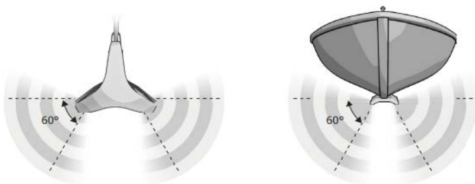
Εικόνα 5: Γωνίες εκπομπής ενός SONAR πλευρικής σάρωσης
