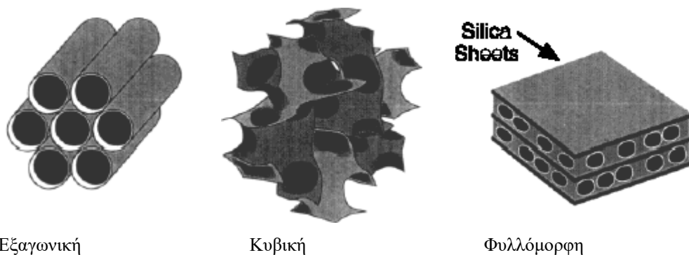
Σχήμα 1.1.4 8 Λαμβανόμενες δομές πυριτικών στερεών μετά την απομάκρυνση των επιφανειοδραστικών μορίων.
