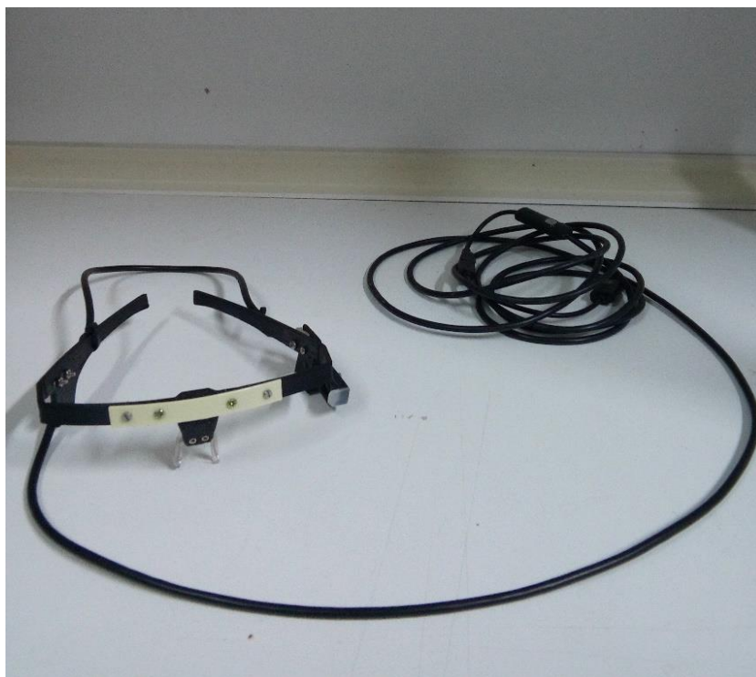
Εικόνα 18: Ο σκελετός των γυαλιών με την ενσωματωμένη κάμερα.
