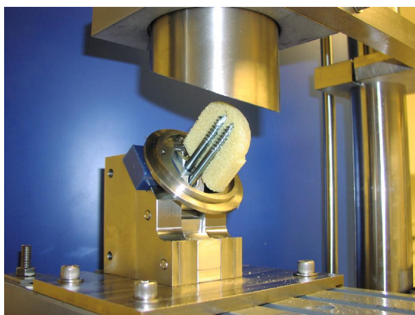
Εικόνα 2. Οι δύο κοχλίες τοποθετήθηκαν σε οστικά ομοιώματα από πολυουρεθάνη (Sawbones, Pacific Research Inc., Vashon, WA)
