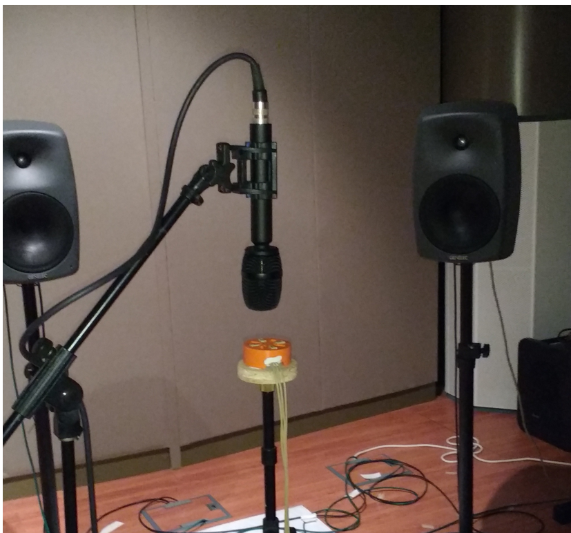
Εικόνα 20: Τοποθέτηση των δύο τύπων μικροφώνων κατά τη φάση της σύλληψης του ηχητικού πεδίου
