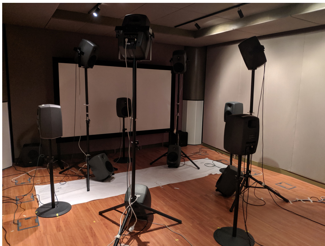
Εικόνα 23: Διάταξη 12 ηχείων στο Acoustic Lab σε σχήμα σφαίρας.
