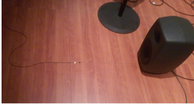
Εικόνα 13: Τοποθέτηση ηχείου - μικροφώνου κατά την διαδικασία βαθμονόμησης της κάρτας ήχου.
