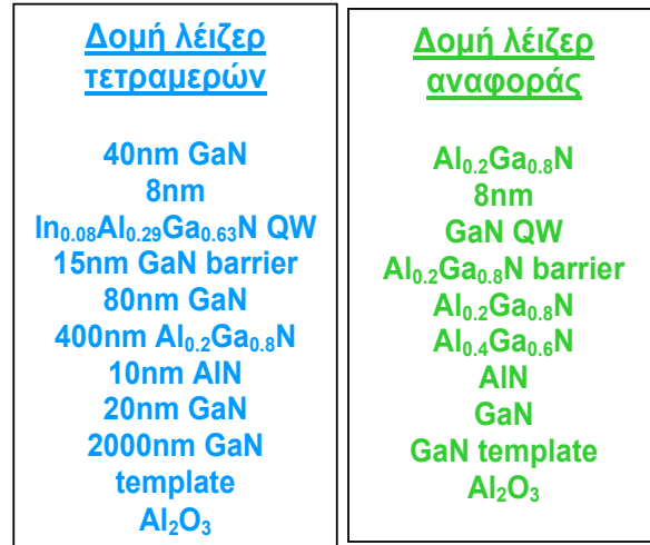
Σχήμα 4.2 Οι δομές λείζερ με τετραμερή (αριστερά) και αναφοράς (δεξιά).
