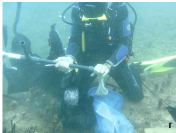
Εικόνα 3. Ο συλλέκτης αναρρόφησης με αέρα (ΣΑΝΑ): Α) απεικόνιση του ΣΑΝΑ (τροποποιημένη από Chatzigeorgiou et al. 2012b), Β),Γ) χρήση του ΣΑΝΑ κατά τη διάρκεια της δειγματοληψίας
