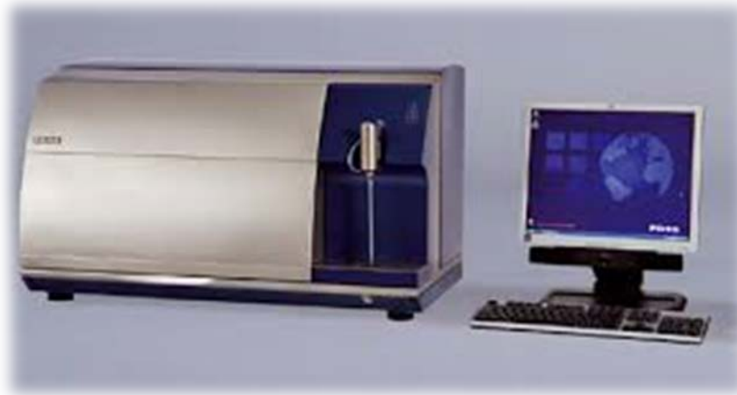
Εικόνα 4.4.1 Αυτοματοποιημένος αναλυτής γάλακτος υπέρυθρης ακτινοβολίας (Συσκευή Milkoscan) συνδεδεμένος με ηλεκτρονικό υπολογιστή
