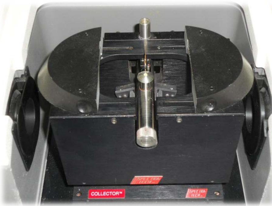
Εικόνα 4.4.6 Υποδοχέας δείγματος που φέρει καψίδιο με το δείγμα
