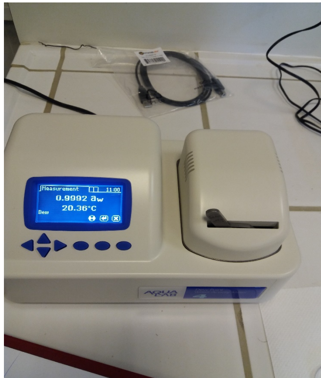
Εικόνα 4.4.4 Ειδικό όργανο μέτρησης ενεργότητας νερού a_w (Dew Point Water Activity Meter, Aqua Lab).
