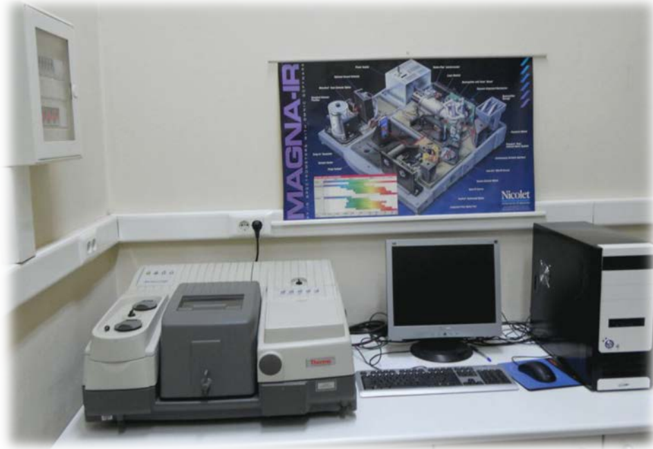
Εικόνα 4.4.5 Το φασματοφωτόμετρο FT-IR Thermo Nicolet 7600 που χρησιμοποιήθηκε.
