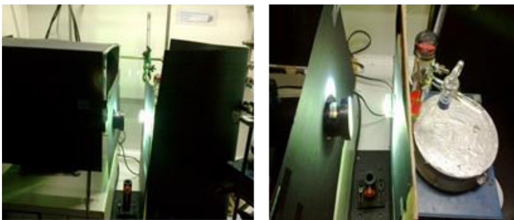
Εικόνα 11 Διάταξη πειράματος φωτοκαταλυτικής παραγωγής H_2 χρησιμοποιώντας ένα narrow band filter για μήκος κύματος 572 nm.
