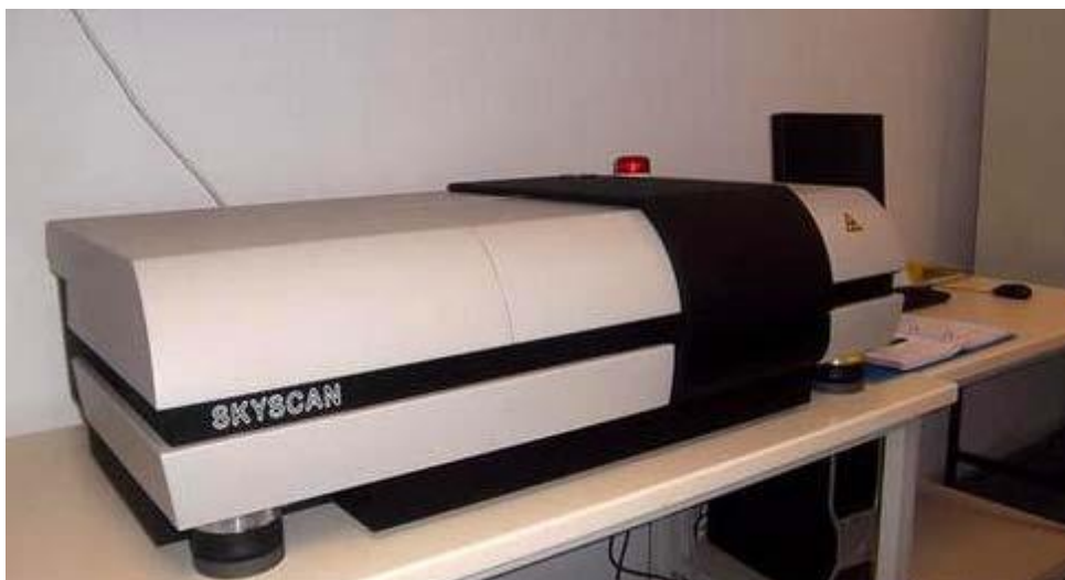
Εικόνα 2.4: Ο μικροτομογράφος SkyScan 1172 εγκατεστημένος στα εργαστήρια του στο Ινστιτούτο Θαλάσσιας Βιολογίας, Βιοτεχνολογίας και Υδατοκαλλιεργειών.
