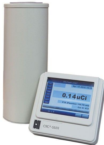
Εικόνα 28. Θάλαμος ιονισμού τύπου πηγαδιού, CAPINET CRC-55TR.
