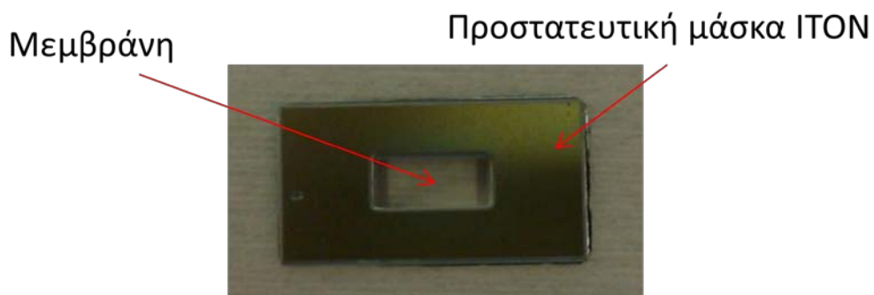
Εικόνα 5.25: Οπίσθια πλευρά ακουστικής συσκευής τύπου Lamb. Διακρίνεται η προστατευτική μάσκα ITON.
