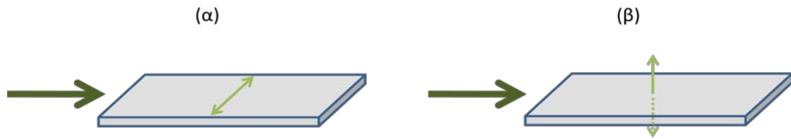
Εικόνα 2.6: Διαφορετική πόλωση ταλάντωσης των ατόμων του κρυστάλλου σε σχέση με την επιφάνεια της συσκευής - (α) Παράλληλα και (β) κάθετα κύματα ως προς την επιφάνεια.
