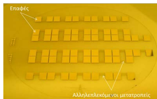
Εικόνα 4.5: Δισκίο 3" χαλαζία πάνω στο οποίο έχουν κατασκευαστεί ακουστικές συσκευές. Διακρίνονται οι επαφές και οι αλληλεπλεκόμενοι μετατροπείς.
