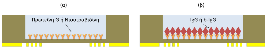
Εικόνα 6.14: (α) Διαμόρφωση επιφάνειας με πρωτεΐνη G ή νιουτραβιδίνη και (β) Αλληλεπίδραση αντισώματος IgG ή b-IgG με την διαμορφωμένη από πρωτεΐνη G ή νιουτραβιδίνη επιφάνεια.
