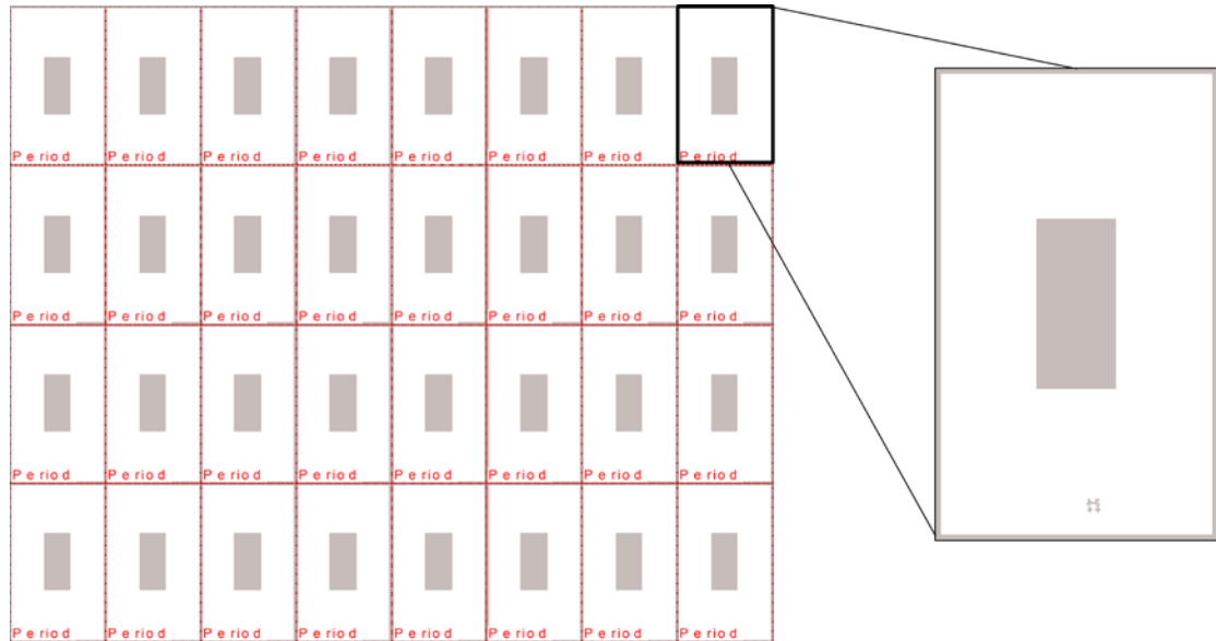
Εικόνα 5.20: Σχέδιο 3 ης φωτολιθογραφικής μάσκας που χρησιμοποιήθηκε για την κατασκευή του αισθητήρα τύπου Lamb.
