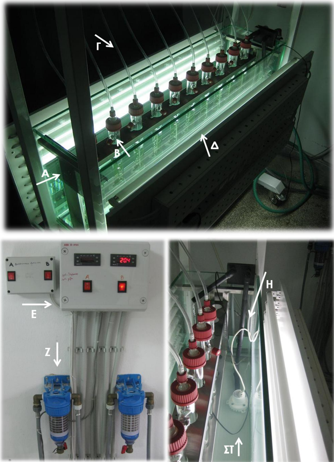
Εικόνα 16. Ένα εκ των 2 συστημάτων καλλιέργειας του μικροφύκου Chlamydomonas reinhardtii που διαθέτει το εργαστήριο Βιοχημείας και Βιοτεχνολογίας Φυτών του Τ.Ε.Ι. Κρήτης. Το κάθε σύστημα περιλαμβάνει δεξαμενή νερού (Α), μέσα στην οποία τοποθετούνται 10 βιοαντιδραστήρες (Β), σύστημα παροχής αέρα (Γ) καθώς και λάμπες ψυχρού φωτισμού (Δ). Η θερμοκρασία ρυθμίζεται από έναν ψηφιακό ελεγκτή θερμοκρασίας (Ε) μέσω ενός σένσορα (ΣΤ) που τοποθετείται μέσα στη δεξαμενή νερού. Το νερό περνά μέσα από φίλτρα (Ζ) με τη βοήθεια αντλιών (Η) και ανακυκλώνεται.
