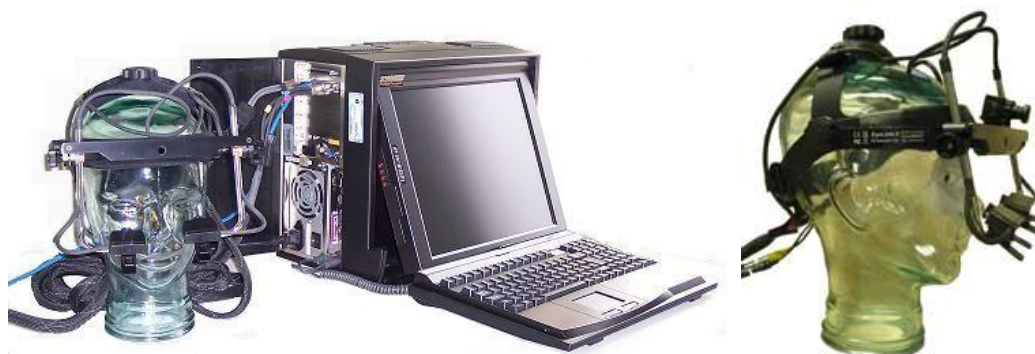
Σχήμα 29: Αριστερά: Το σύστημα ανίχνευσης – καταγραφής οφθαλμικών κινήσεων Eyelink II, SR Research. Δεξιά: Η κάσκα με τις προσαρμοσμένες σε αυτή κάμερες ανίχνευσης. (από www.eyelinkinfo.com )
