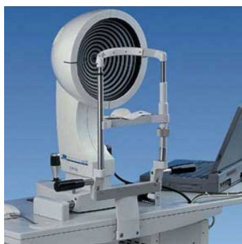
Εικόνα 22: τοπογράφος με μεγάλο κώνο για μέτρηση χωρίς επαφή με το μάτι του εξεταζόμενου.
