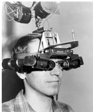
Εικόνα 1. «Sword of Damocles», η πρώτη επικεφαλής οθόνη στον κόσμο, Ivan Sutherland, 1968.
