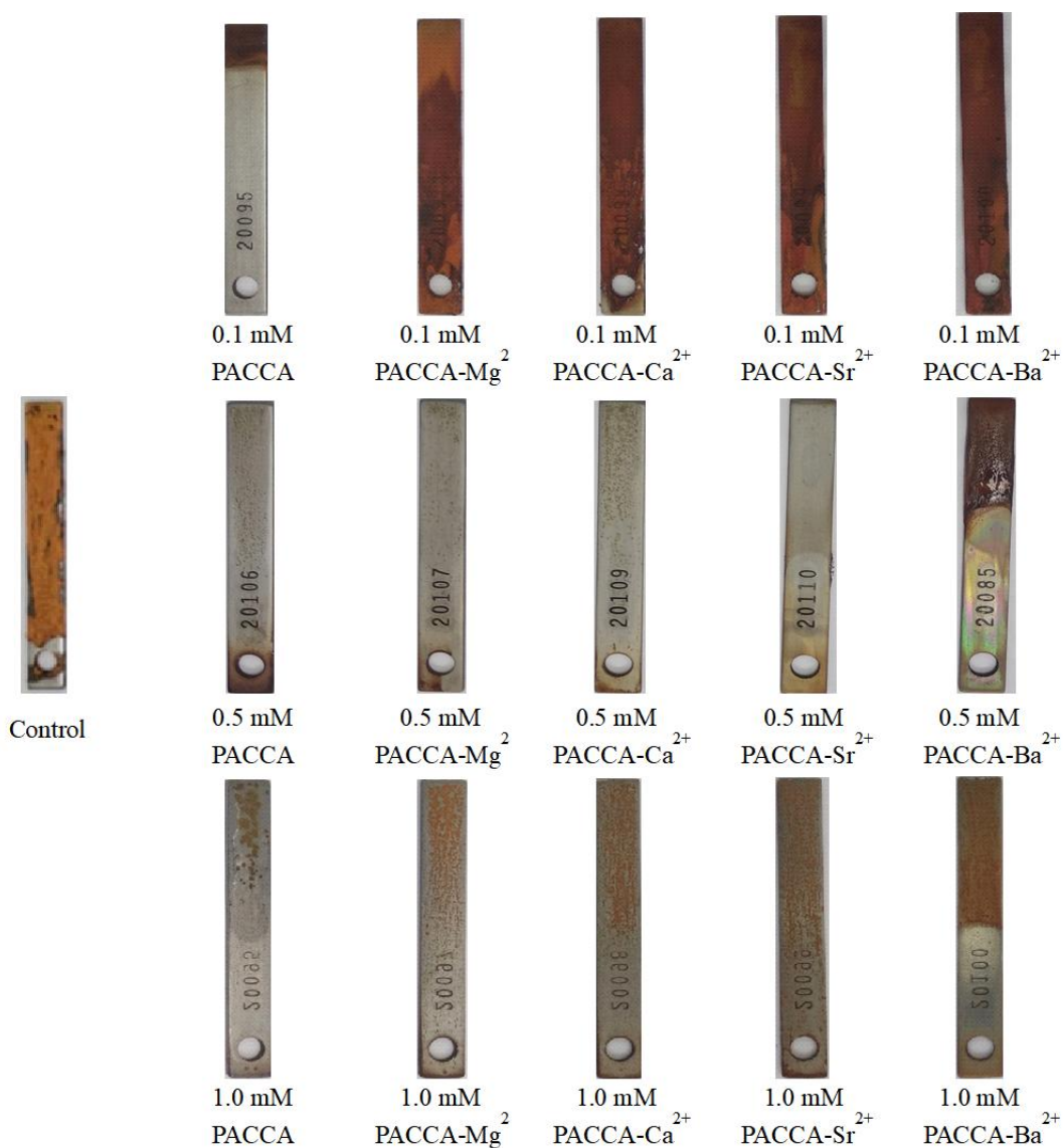
Εικόνα 3.3.14: Οπτικές παρατηρήσεις της επίδρασης των παρεμποδιστών PACCA, PACCA-Mg 2+ , PACCA-Ca 2+ , PACCA-Sr 2+ και PACCA-Ba 2+ στη διάβρωση δοκιμίων χάλυβα σε pH = 5 και συγκέντρωση 0.1 mM, 0.5 mM και 1.0 mM
