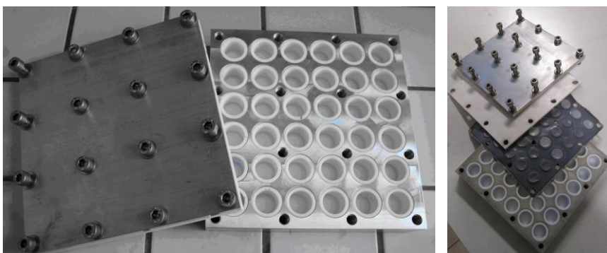
Εικόνα 1.11 Σύστημα HT με 36 θέσεις αντιδράσεων που χρησιμοποιήθηκε στην παρούσα εργασία. Ο όγκος του κάθε μικροαντιδραστήρα είναι 5 mL.
