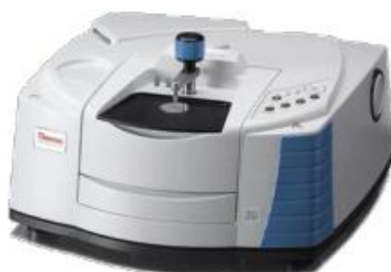
Εικόνα 3.5: Φασματόμετρο Υπέρυθρου με Μετασχηματισμό Fourier (FTIR) Nicolet 6700 Thermoscientific, με Αποσβένουσα Ολική Ανάκλαση (ATR)
