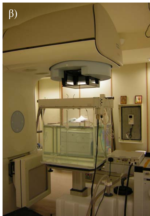
Σχήμα 5.2. α) Η αρχή του δοσιμετρικού συστήματος RFA-300 Wellhofer και β) η πειραματική διάταξη που χρησιμοποιήσαμε.
