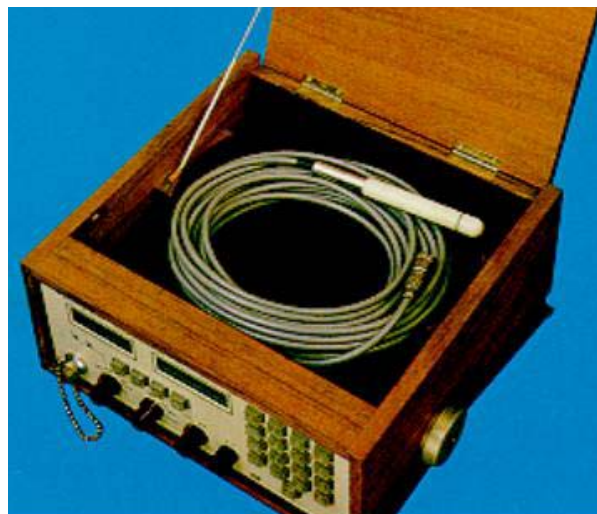
Σχήμα 4.4. Ένας θάλαμος ιονισμού τύπου Farmer (0.6 cc) μαζί με το ηλεκτρόμετρο του.
