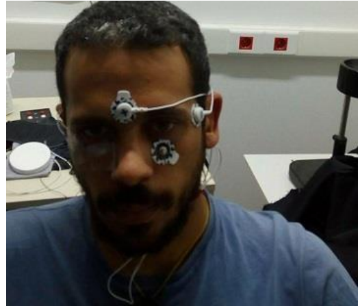
Εικόνα 16: Στον αριστερό οφθαλμό τα ηλεκτρόδια του CED 1902 και στον αριστερό του Bitalino για τη θέση 13
