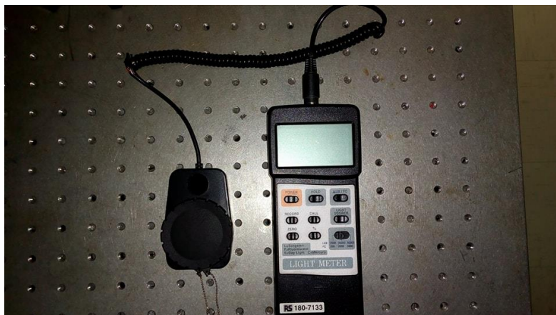
Εικόνα 8: Το φωτόμετρο που χρησιμοποιήθηκε στις μετρήσεις.
