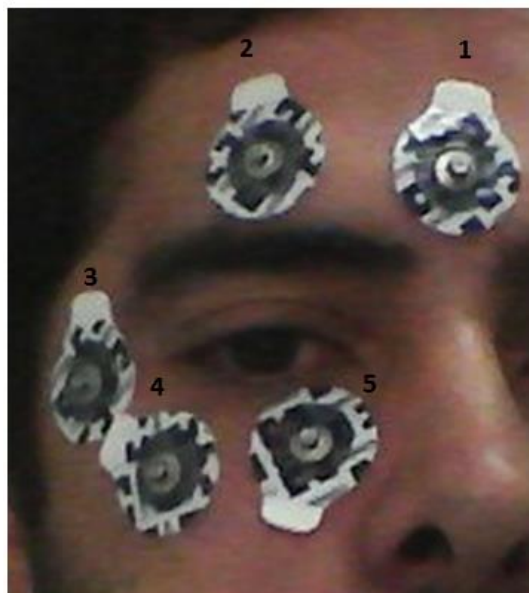
Εικόνα 11: Οι 5 θέσεις γύρω από το μάτι όπου τοποθετήθηκαν τα ηλεκτρόδια και προέκυψαν 10 συνδυασμοί ώστε να βρεθεί η κατάλληλη θέση που θα τοποθετηθούν τα ηλεκτρόδια.
