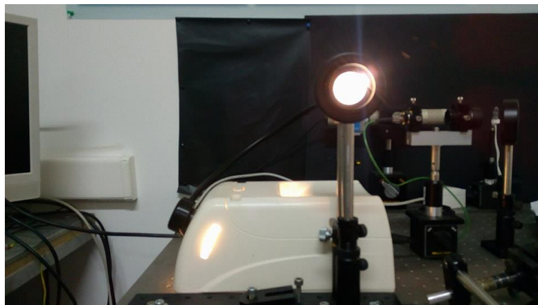
Εικόνα 7: Η λάμπα αλογόνου ως φωτεινή πηγή.
