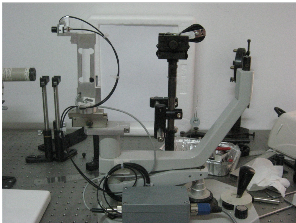
Εικόνα:34. Οπτική διάταξη βαθμονόμησης δύναμης από αυθαίρετες μονάδες σε mNewton.
