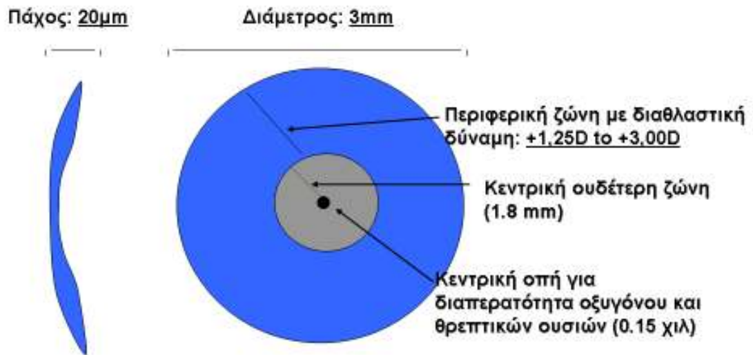
Εικόνα 5: Απεικονίζεται διάγραμμα του κερατοειδικού ενθέματος Invue Lens (Biovision)
