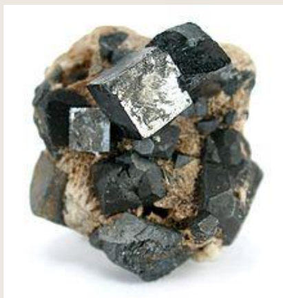
Εικόνα 9: Κρυσταλλική δομή ενός perovskite ( εδώ \text{CaTiO}_3 )
