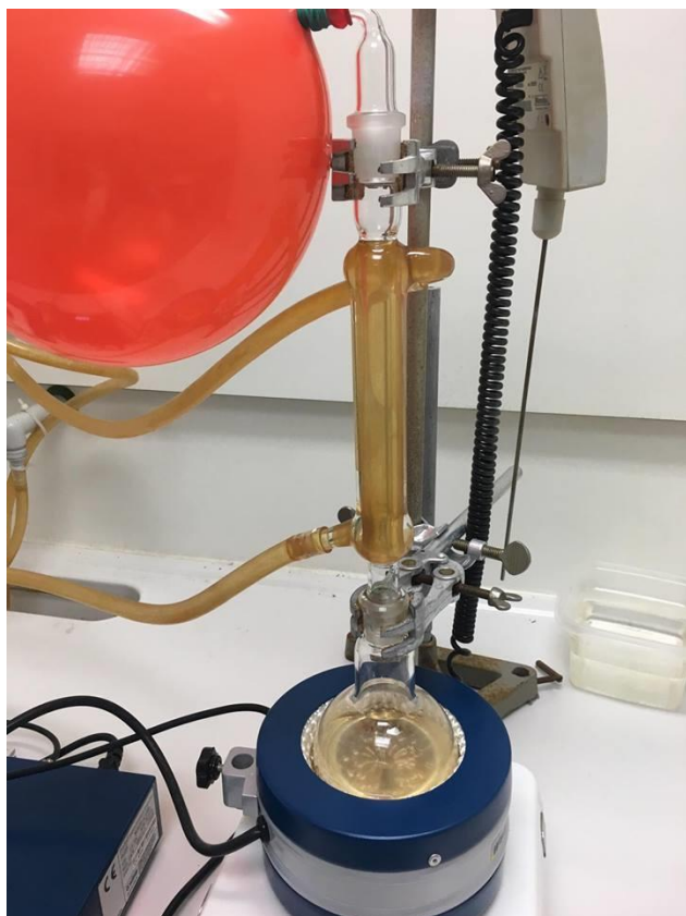
Εικόνα 4: Reflux μετά την προσθήκη του tetrakis-triphenyl phosphine palladium
