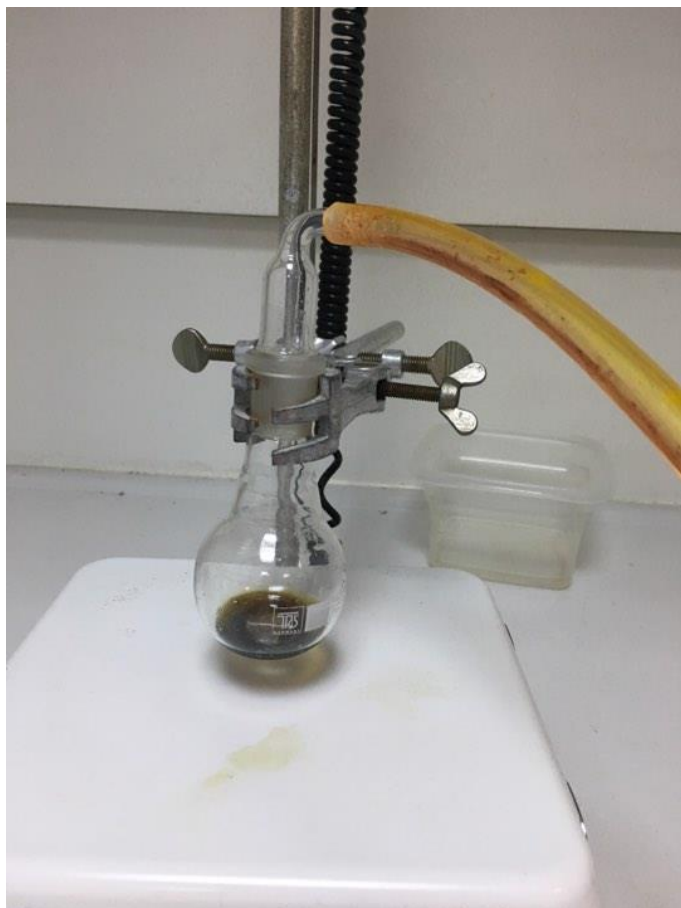
Εικόνα 5: Αφαίρεση διαλύτη μέσω κενού
