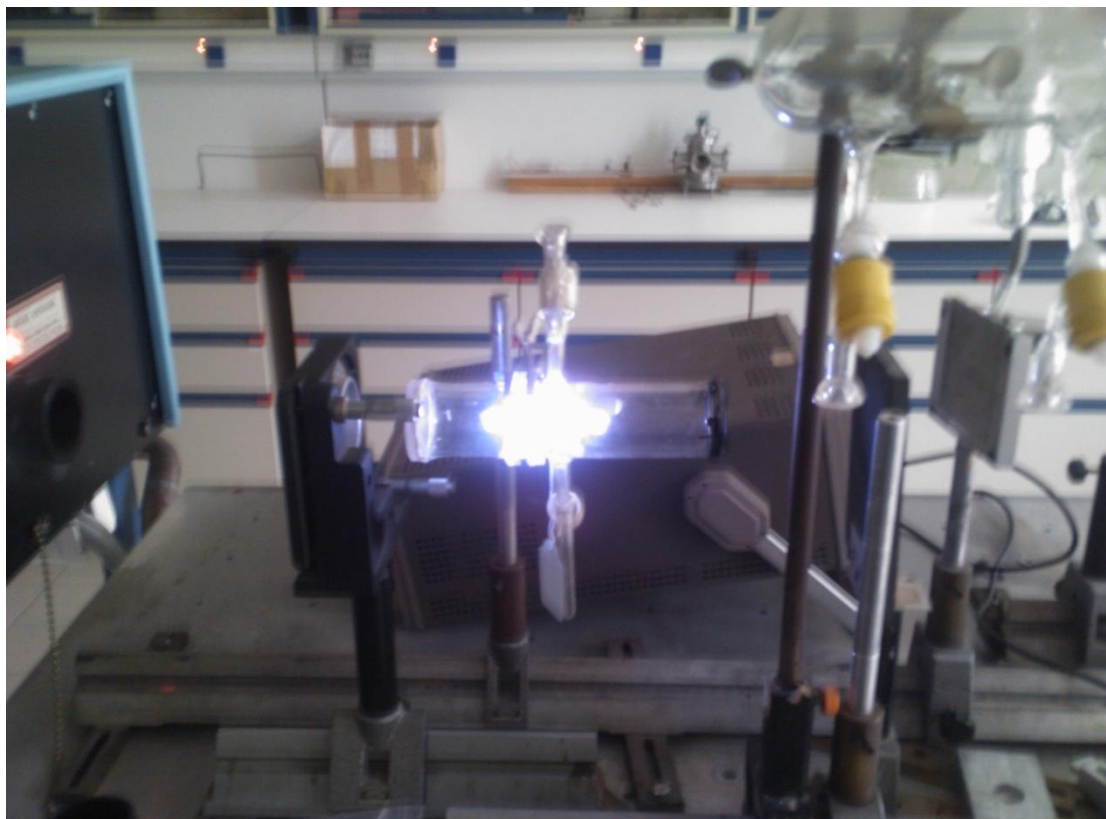
Εικόνα 7.2 Απεικόνιση πειραματικής διάταξης του Θερμοστατούμενου Φωτοχημικού Αντιδραστήρα TPCR/LACVD (Thermostated Photochemical Reactor/Laser Assisted Chemical Vapour Deposition) που χρησιμοποιήθηκε για τη σύνθεση θολινών
