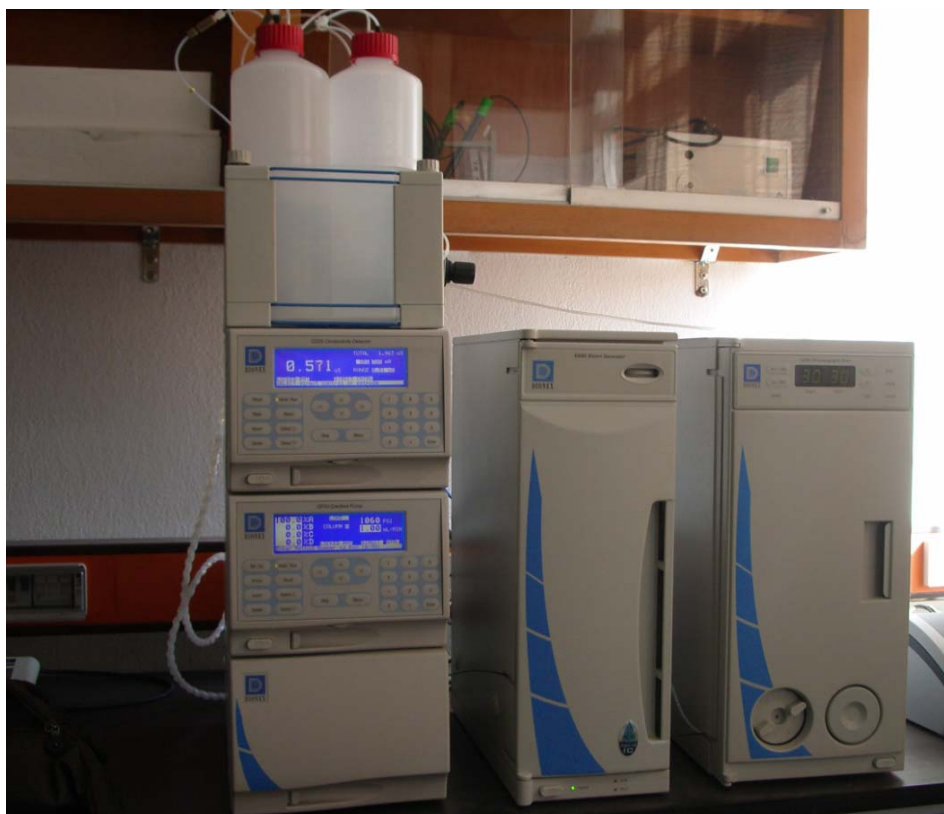
Εικόνα 2.2: Σύστημα ιοντικής χρωματογραφίας τύπου DIONEX.
