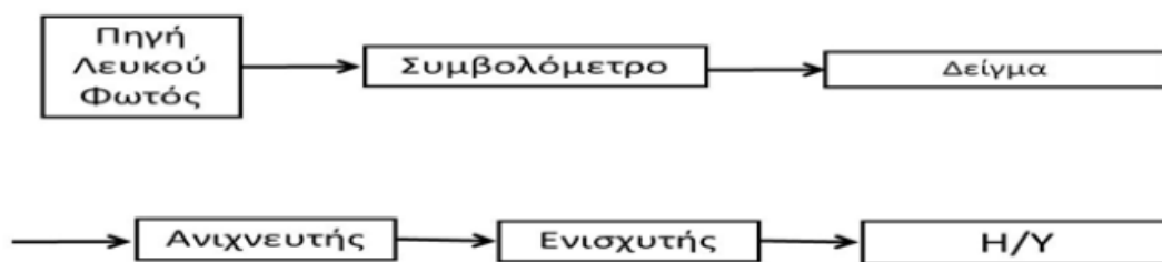
Εικόνα 2.3. Οργανολογία φασματόμετρου FT-IR
