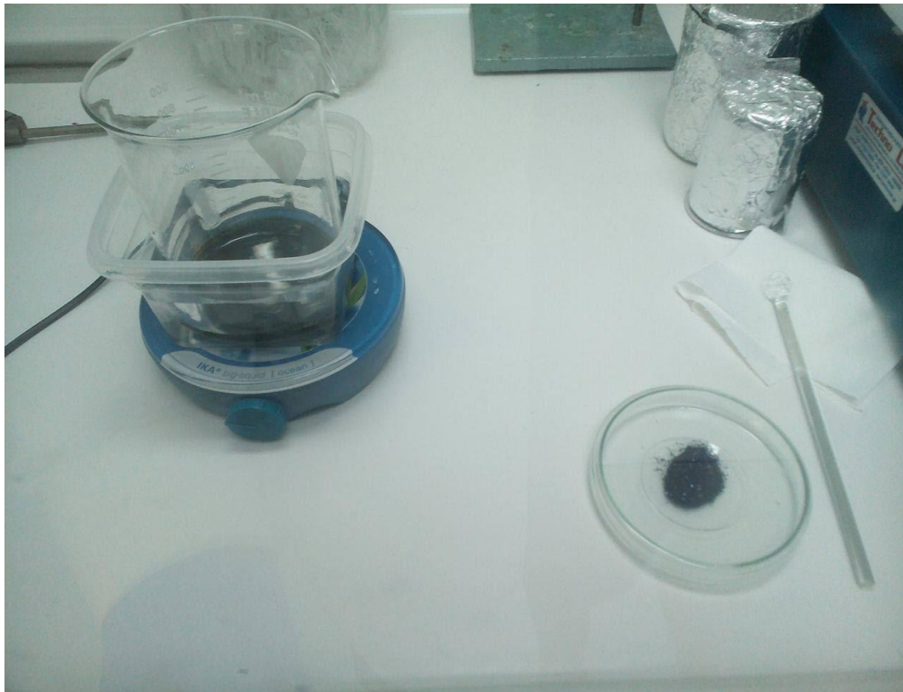
Εικόνα 3.1. Πριν την προσθήκη του \text{KMnO}_4 όπου έχουμε το μίγμα μας σε παγόλουτρο υπό ανάδευση.
